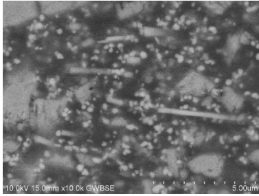
塗膜中の特殊繊維 (電子顕微鏡10000倍)
